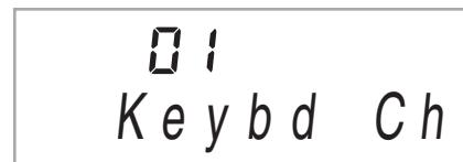
2. С помощью клавиш [-] и [+ ] цифровой клавиатуры (16) поменять номер канала клавиатуры.
