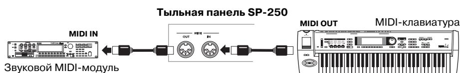
Для коммутации и работы SP-250 с компьютером потребуются компьютерный MIDI-интерфейс, программный секвенсер или нотный редактор и два стандартных MIDI-кабеля. Скоммутируйте разъем MIDI OUT инструмента SP-250 с разъемом MIDI IN компьютера, а разъем MIDI IN SP-250 с разъемом MIDI OUT компьютера.
